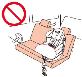
・ ピラーなどに接触して、正しく取り付けできない座席。
