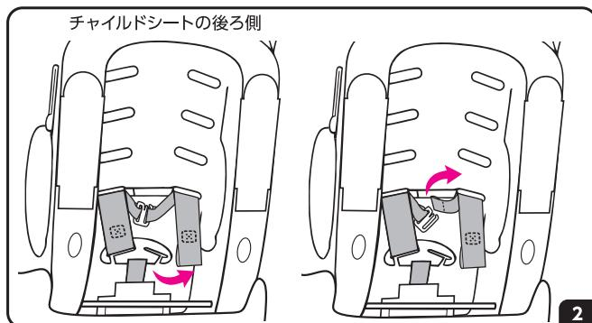
チャイルドシート後ろ側のベルト連結金具からハーネスベルトを外し、同様に肩パッド連結金具から肩パッドベルトを外して、チャイルドシート前側のスロットからハーネスベルトと一緒に引き抜きます。
