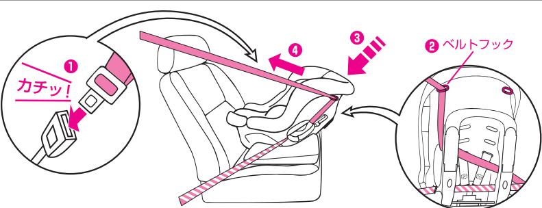
①シートベルトを車のバックルに「カチッ！」と音がするまで差し込みます。②車のシートベルトをベルトフックにかけます。③チャイルドシートに体重をかけながら④肩側のシートベルトを矢印の方向に強く引きます。
