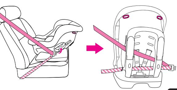
ベルト通しホールにシートベルトをねじらない様に通し、反対側のホールから引き出します。
