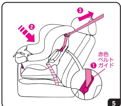
①赤色ベルトガイド(クリップ式)に通した後、②チャイルドシートの本体に体重をかけ、③肩側のベルトを矢印の方向に強く引きます。
