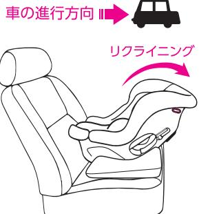
チャイルドシートを車の進行方向後ろ向きに座席の背もたれに接するよう設置します。リクライニングバーを引いて3段目のリクライニングポジション（一番倒れたポジション）にセットします。
