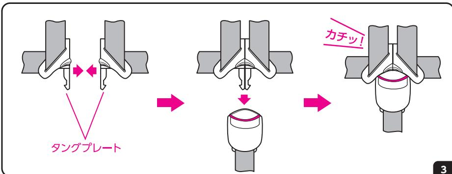
バックルを脚の間から引っ張り出し、ハーネスベルトの二つのタングプレートを重ね合わせ、バックルに「カチッ」と音が鳴るまでしっかりと差し込んでください。
