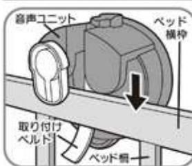
①取り付けベルトが、ベビーベッド柵の間にくるように、音声ユニットをベビーベッドの横枠にかけます。
