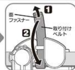
③通した取り付けベルトを上方①に引っ張り、面ファスナー②を合わせて固定します。
