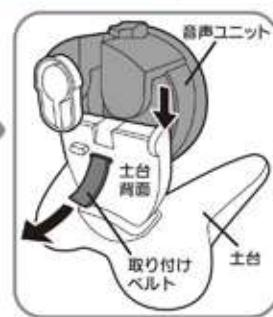
②土台背面から出てきた取り付けベルトを矢印の方向に引っ張りながら音声ユニットを土台にはめ込みます。
