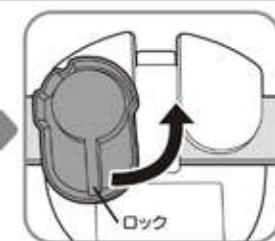
④ロックを矢印の方向に回します。カチッと音がしてロックが戻らなければ、取り付け完了です。
