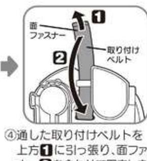
④通した取り付けベルトを上方①に引っ張り、面ファスナー②を合わせて固定します。
