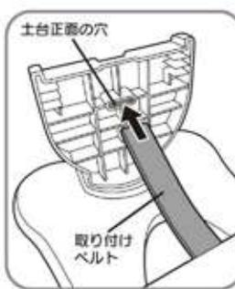
①土台正面の穴に、取り付けベルトを通して下さい。
