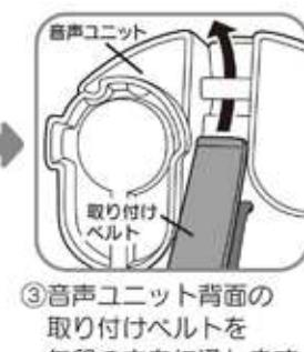
③音声ユニット背面の取り付けベルトを矢印の方向に通します。
