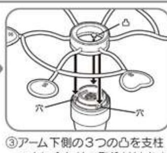
③アーム下側の3つの凸を支柱の穴に合わせて取り付けます。
