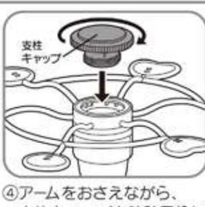
④アームをおさえながら、支柱キャップを時計回りに回して固定します。
