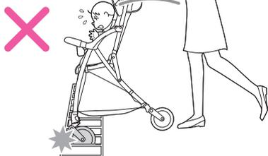
車輪が溝に挟まったときには、挟まった車輪の脚パイプとハンドルを持って、車輪を引き抜いてください。その際はお子さまが落下しないように十分注意してください。
