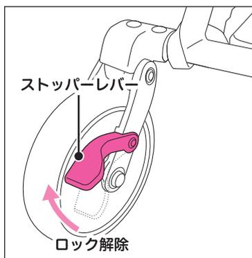
左右両方の後輪をロック解除してください
